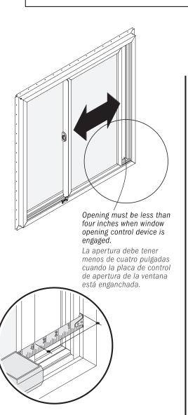
To Disengage Dual Action Window Opening Control Device Para desenganchar la placa de control de apertura de la ventana de doble accionamiento
