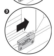
Close sash. Window opening control device automatically resets. Cierre la hoja. La placa de control de apertura de la ventana vuelve a su posición inicial automáticamente.
